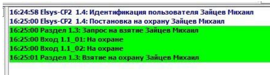
Рисунок 21 – Последовательность событий при централизованном управлении режимом охраны глобального раздела с клавиатуры Elsys-CP2
